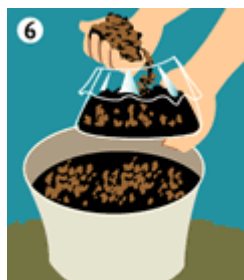
Figura 6: Para enviar al laboratorio, tome del balde una porción de 500 g (muestra compuesta).
