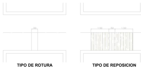
e. **Rotura Tipo Fuera del Eje de la Vía :** Son aquellas que se realizan a lo largo de un carril de una calzada (Ver Gráfico). En este caso, la recuperación del pavimento, se deberá realizar a partir del borde externo del sardinel hasta el eje de la calzada (Ver gráfico).
